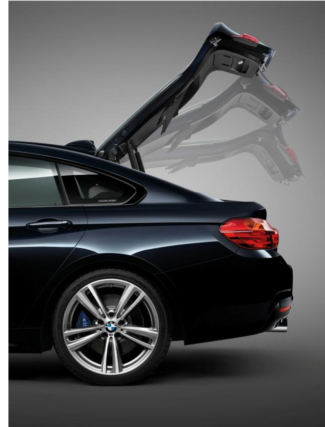
Ouverture et fermeture automatique du hayon de série.
